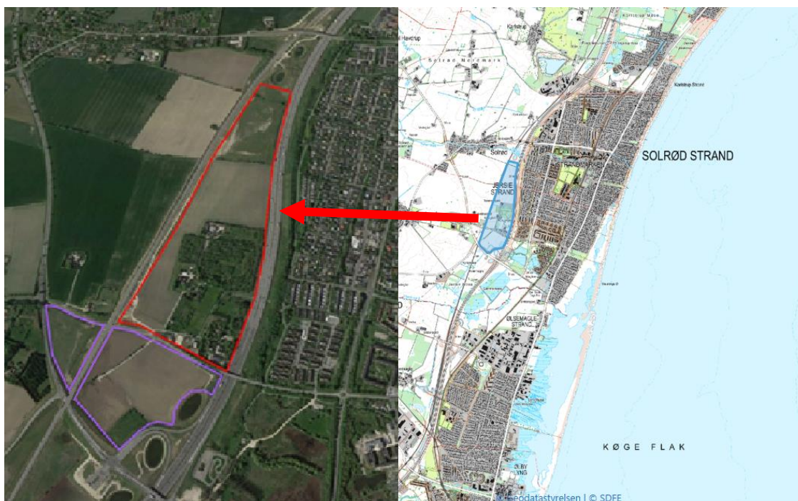
Figur 1 Afgrænsning af spildevandsplantillægget. Overfladevand fra den røde polygon forventes afledt til KLAR Forsynings regnvandssystem, mens overfladevand fra den lille polygon forventes håndteret internt i området med egen forsinkelse, rensning og udledning.
